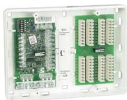
Die Meldergruppenmodule sind die Schnittstelle zwischen konventioneller Anschlußtechnik (Kontakte) und dem BUS-1. Je nach Typ können 1 bis 5 Meldergruppen an die Module angeschlossen werden. Sie bieten einen schnellen und kostengünstigen Weg eine große Anzahl von Kontaktmeldern (z. B. Magnetkontakte, Glasbruchmelder) an den Melderbus der Gefahrenmelderzentrale anzuschließen.
